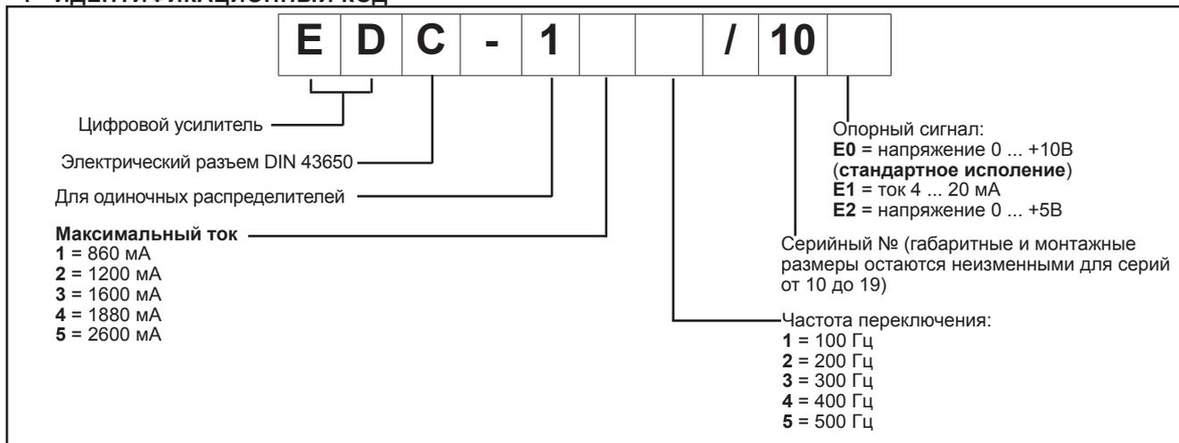
Блок EDC-1 представляет собой миниатюрный электронный блок для управления в режиме без обратной связи пропорциональными клапанами (распределителями). Усилитель подает ток, изменяющийся в зависимости от опорного сигнала, но не зависимо от колебаний температуры или сопротивления нагрузки.
