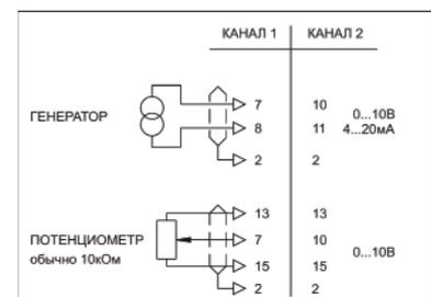
ПРИМЕЧАНИЕ: Контакт 8 (и контакт 11 для версии EDM-M3\*\*) должен быть соединён с контактом 15 (0 В), когда потенциометр используется как опорный сигнал. Это также рекомендуется, когда генератор имеет чистый дифференциальный выход (не заземлён).
