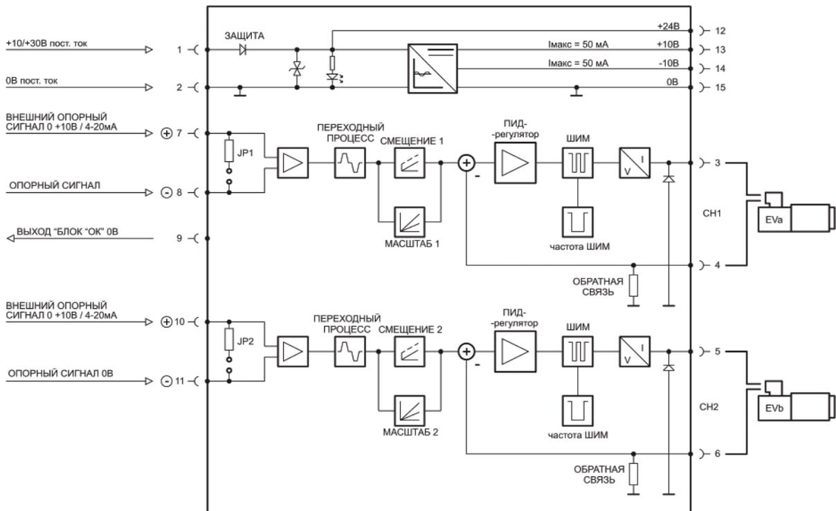
11 - ЭЛЕКТРИЧЕСКАЯ СХЕМА ДЛЯ ОПОРНОГО СИГНАЛА
