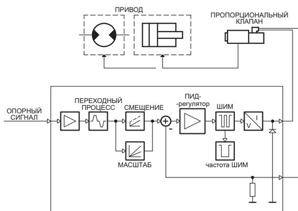
Электронный блок EDM-M\* представляет собой цифровой усилитель для управления пропорциональными распределителями без обратной связи. Устанавливается на рейку DIN EN 50022. Усилитель подаёт ток, прямопропорциональный опорному сигналу и не зависящий от колебаний температуры или сопротивления нагрузки.
