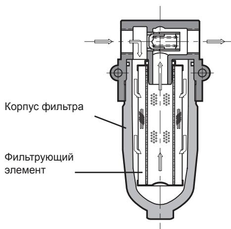
— Фильтры FPM разработаны для установки в магистрали с резьбовыми присоединительными отверстиями BSP для гидравлических соединений. В головке фильтра сделаны резьбовые отверстия на случай возможной установки кронштейна.
