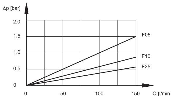
**ПРИМЕЧАНИЕ 2:** Размер фильтра следует выбирать таким образом, чтобы при номинальном расходе перепад давления был ниже 0.8 бара.
