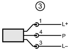
1 2 - проводная схема подключения
