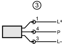
1 2 - проводная схема подключения
