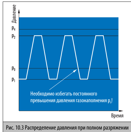
Рис. 10.3 Распределение давления при полном разрядении
