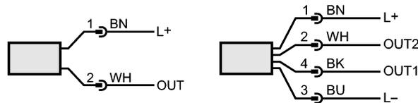
2 - проводная схема подключения
