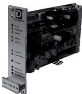
**ЭЛЕКТРОННЫЙ БЛОК УПРАВЛЕНИЯ ДЛЯ ПРОПОРЦИОНАЛЬНЫХ РАСПРЕДЕЛИТЕЛЕЙ С ОДНИМ ЭЛЕКТРОМАГНИТОМ И ОБРАТНОЙ СВЯЗЬЮ ПО ПОЛОЖЕНИЮ ЗОЛОТНИКА СЕРИЯ 52**
