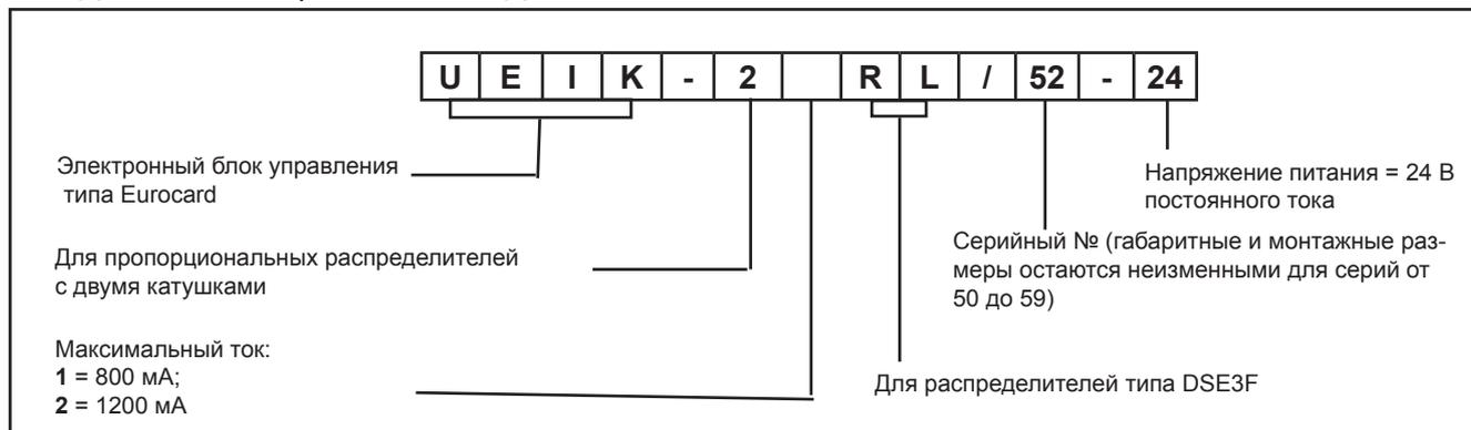
UEIK-2\*RL представляет собой блок типа Eurocard для управления в режиме без обратной связи электромагнитными пропорциональными клапанами с возможностью выбора одной из 4-х фиксированных настроек опорного сигнала и переходного процесса.
