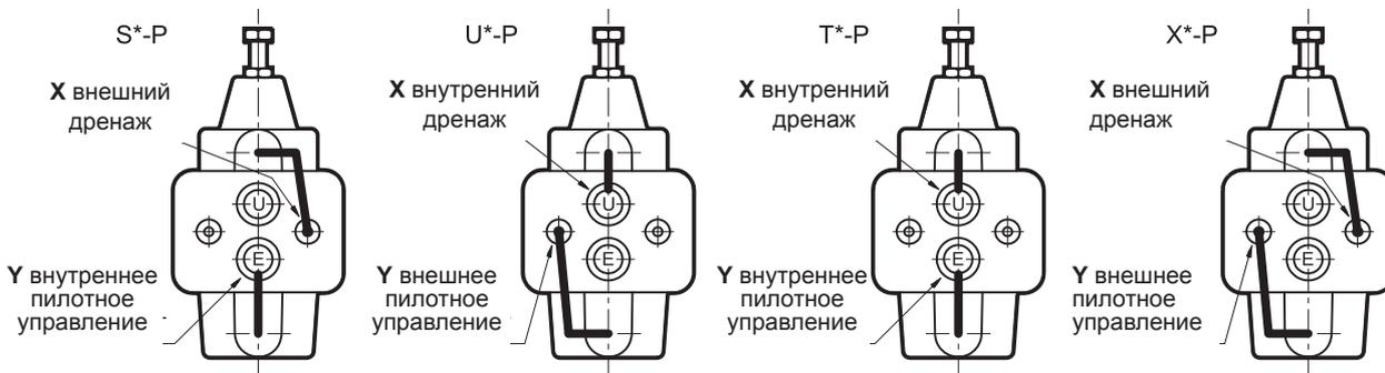
**ПРИМЕЧАНИЕ:** у клапанов данного типа порт Y является отверстием управления, в то время как порт X - дренажным отверстием
